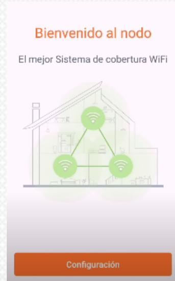
6. Detecta nuestra conexión a internet de forma automática, después nos solicitará poner un nombre y contraseña a nuestra nueva red Wifi de nuestros dispositivos mesh (Los equipos funcionan en 2.4 y 5 GHz, configuran las dos bandas automáticamente)
